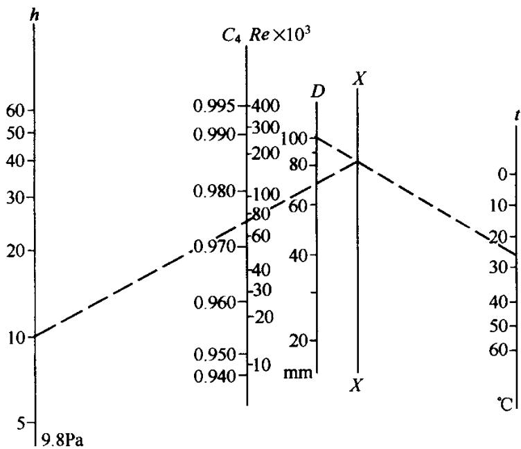
图 A. 2. 7-3 喷嘴流量系数推算图
